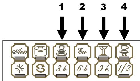
Par exemple, erreur **E7**: si l'erreur **E7** se produit, le buzzer retentira pendant 30 secondes et les indicateurs **2, 3, 4** clignoteront simultanément.
