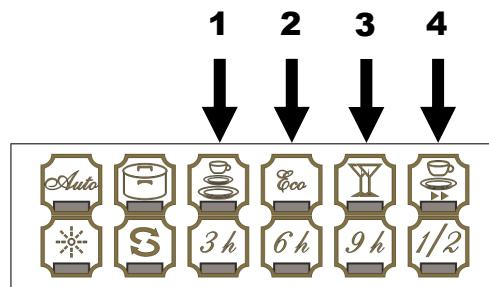
Beispiel Fehler **E7**: Wenn der Fehler **E7** auftritt, ertönt der Summer 30 Sekunden lang und die Anzeigen **2, 3** und **4** blinken gleichzeitig.
