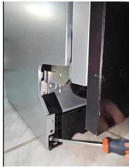
В зависимости от веса вашей смонтированной декоративной панели может быть необходима настройка натяжения пружин. Натяжение пружин осуществляется путём поворачивания винтов **1** и **2**.
